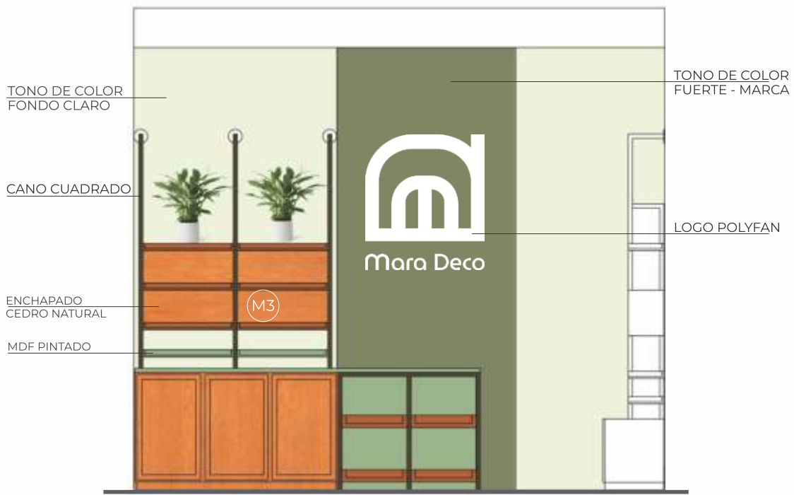
VISTA SECTOR CAJA
