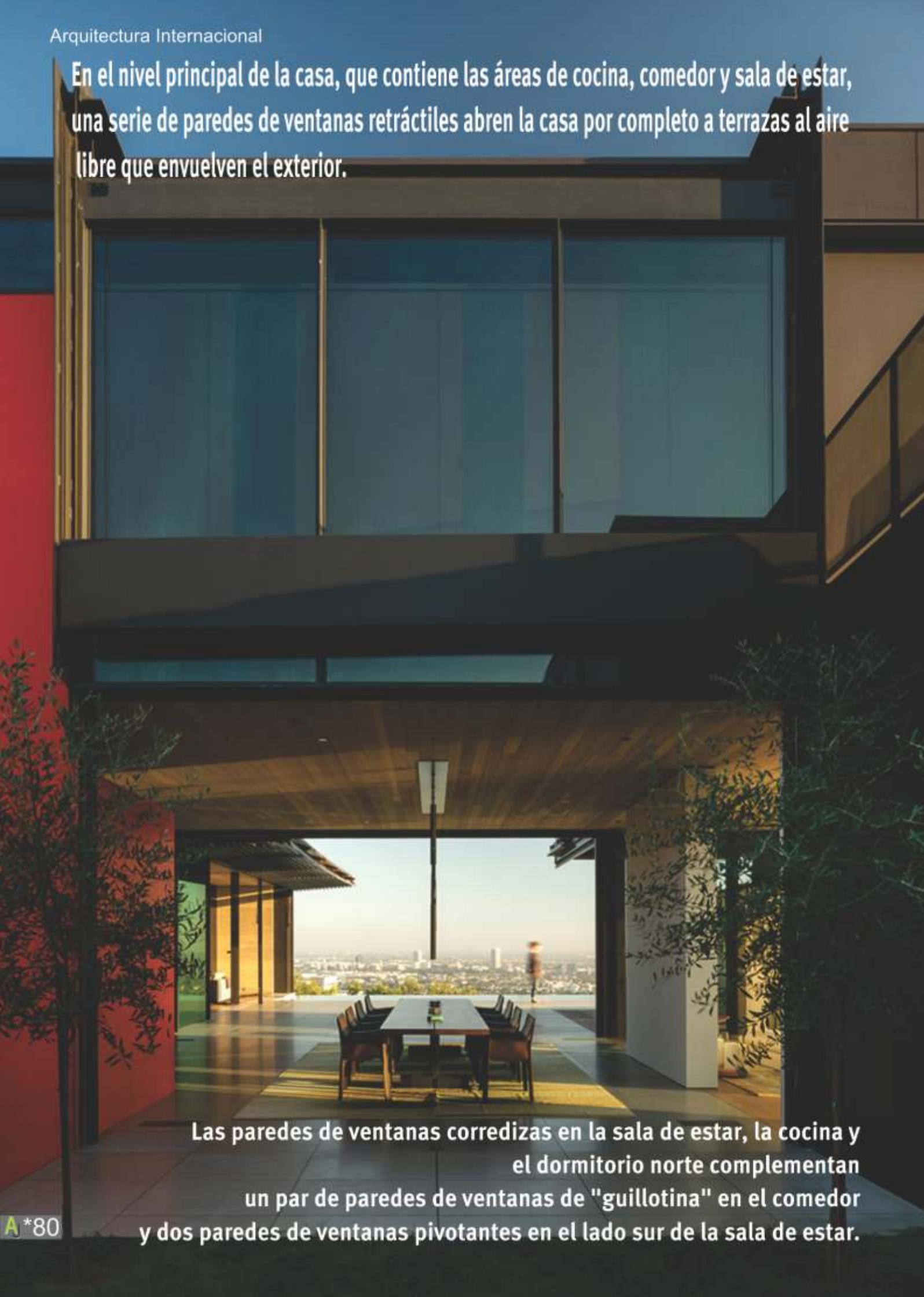
Las paredes de ventanas corredizas en la sala de estar, la cocina y el dormitorio norte complementan un par de paredes de ventanas de "guillotina" en el comedor y dos paredes de ventanas pivotantes en el lado sur de la sala de estar.
